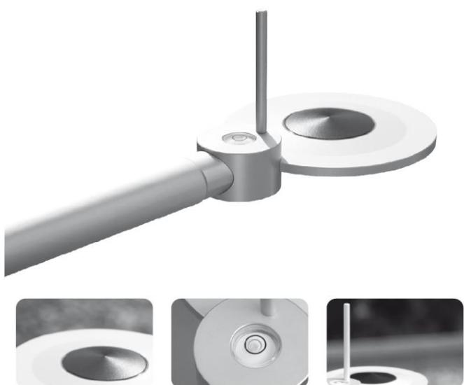
NR-Lite2 は農業や水文学に広く用いられている 1 成分放射収支計です。感部のサーモパイルには、黒色テフロンでコーティングされた円錐状の吸収板が上下両面に取り付けられており、紫外領域 (UV) から遠赤外 (FIR) までの広いスペクトル感度をもっています。信号出力は太陽と上空の放射と地表面の放射の差で、出力は状況に応じてプラスもしくはマイナスになります。
